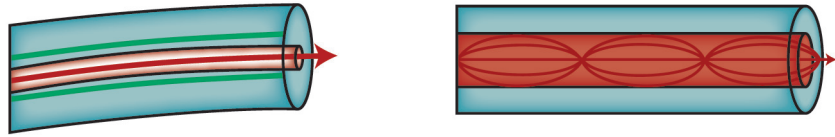
Figura 1.14: Fibra monomodo e multimodo
